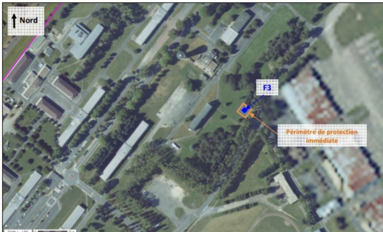
Le périmètre de protection immédiate du forage F3 a une dimension d'environ 20 m sur 20 m. Il est situé sur une partie de la parcelle AB 014. Il est clôturé par un grillage de 2 m de hauteur, l'accès au forage se faisant au moyen d'un portail fermé à clé.
